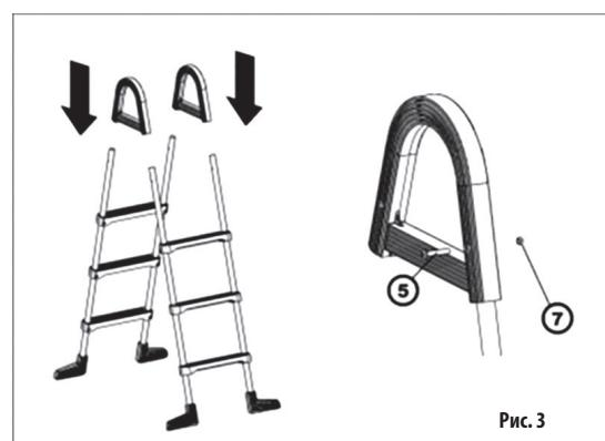
**ПРИМЕЧАНИЕ:** Болты должны быть надежно затянуты, но не затягивайте их слишком сильно; части ступеней могут быть повреждены чрезмерным затягиванием болтов. Затягивайте болт медленно и плавно; как только увидите, что гайка стремится повернуться, то слегка ослабьте болт и осторожно его снова затяните.
