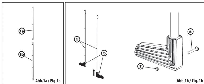
**SCHRITT 2: SETZEN SIE DIE KUNSTSTOFFSTUFEN AUF DIE BEINE**
